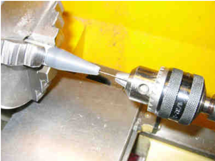
Perçage à l'aide du tour de la tuyère dans l'axe de la torpille
