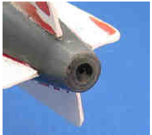
La tuyère percée par un trou de 1 mm de diamètre
